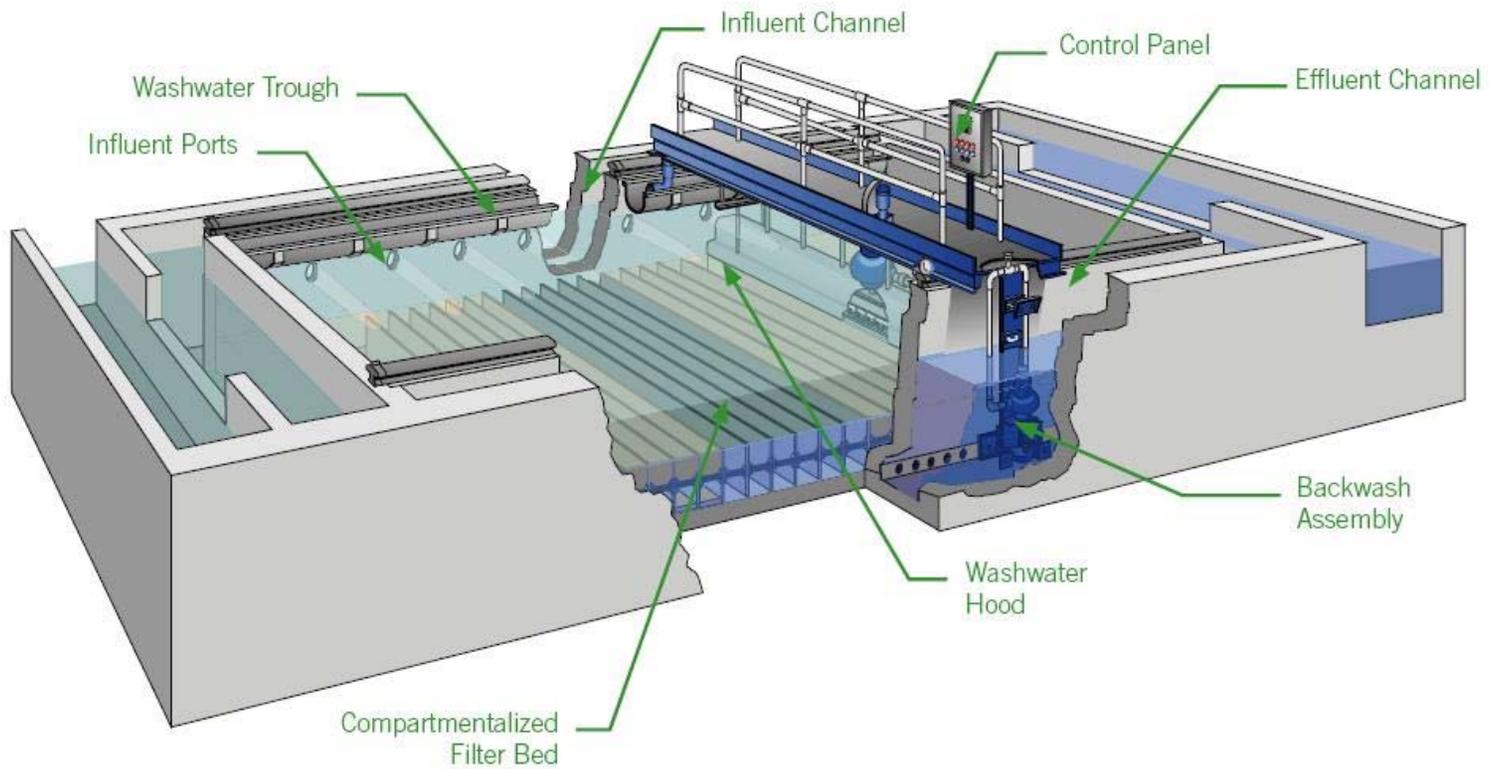
**ILLUSTRATION OF AN AUTOMATIC BACKWASH FILTER (DEGRÉMONT TECHNOLOGIES - INFILCO)**
