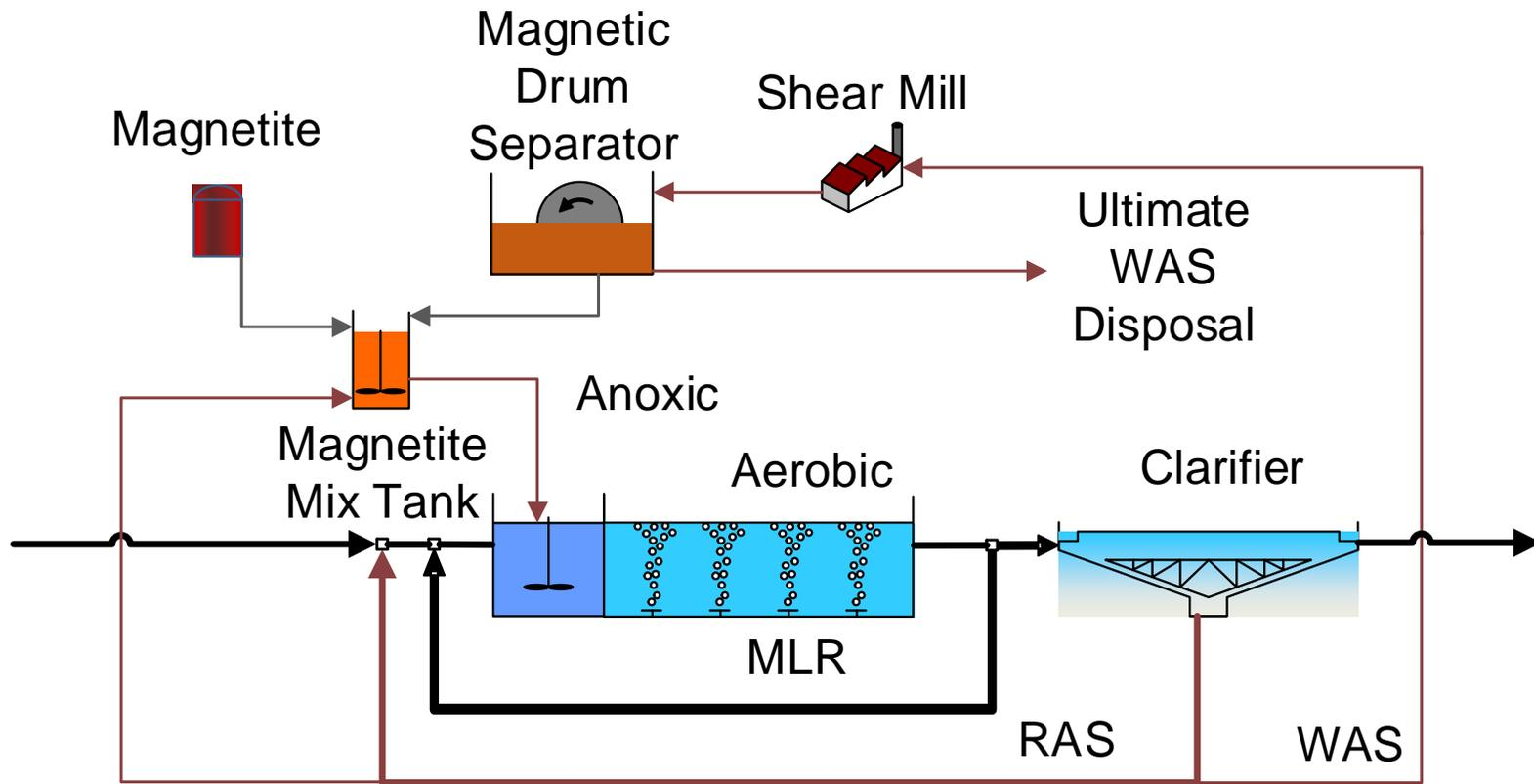
**SCHEMATIC OF A BIOMAG<sup>®</sup>
