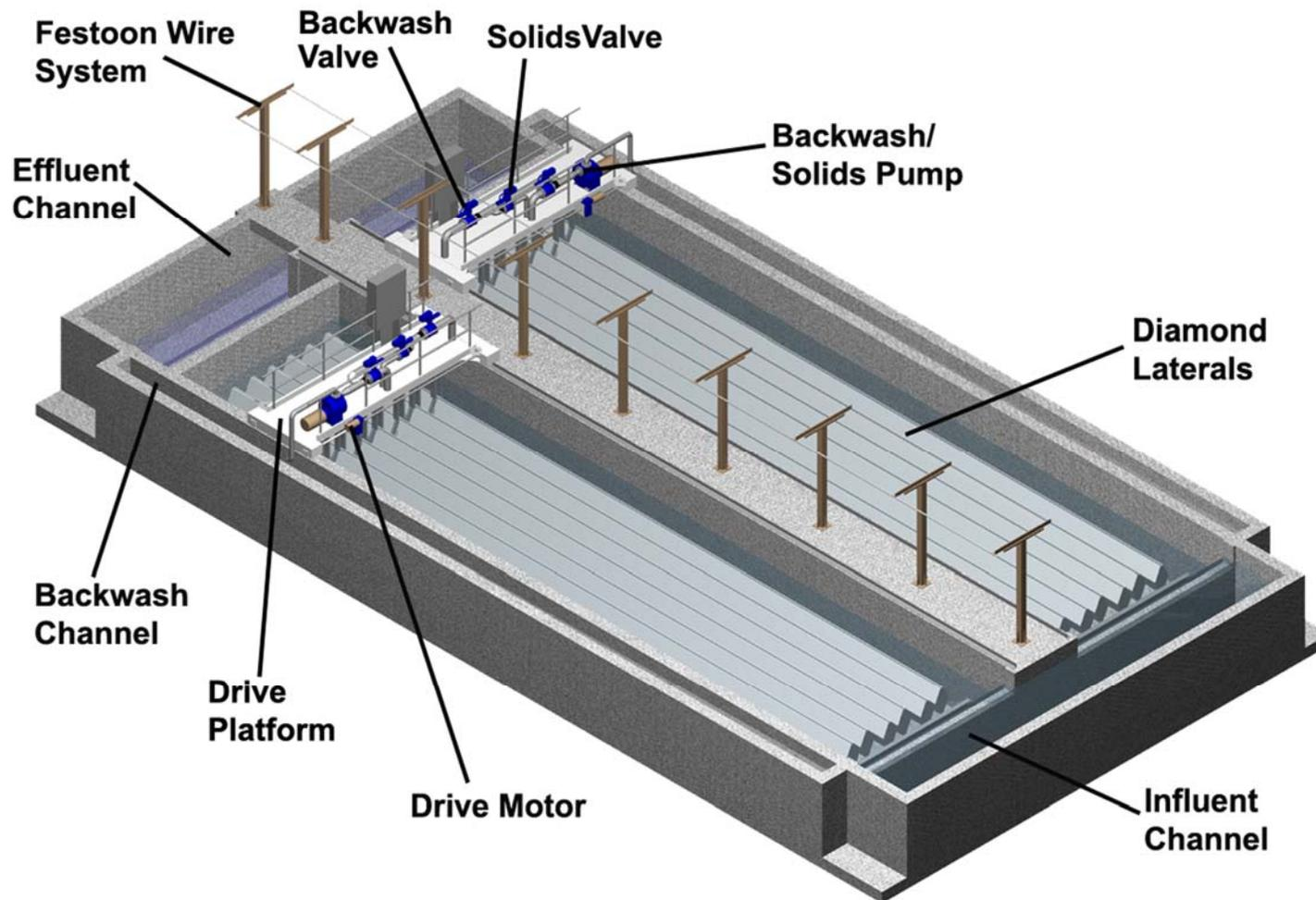
**ILLUSTRATION OF A LATERAL CLOTH MEDIA FILTER (AQUA-AEROBIC SYSTEMS, INC.)**
