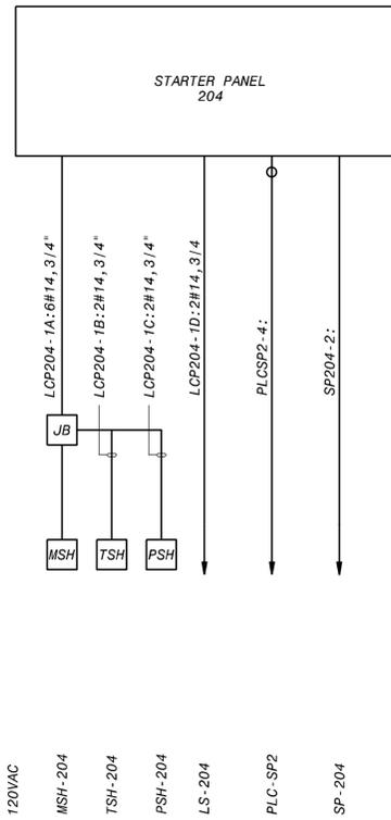
**SCUM PUMP CONTROL PANEL LCP-204 ONE-LINE DIAGRAM**
