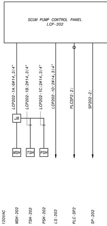
**SCUM PUMP CONTROL PANEL LCP-202 ONE-LINE DIAGRAM**
