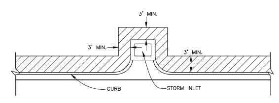
SOD ALONG CURB AND AROUND INLET
