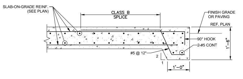
5 - DETAIL - 12" SLAB-ON-GRADE TURN DOWN N.T.S.
