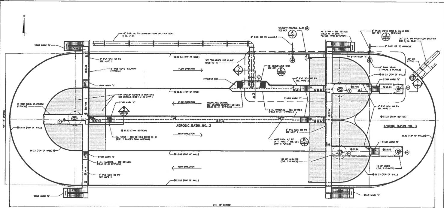
1 ANOXIC / AEROBIC TANK - TOP PLAN
