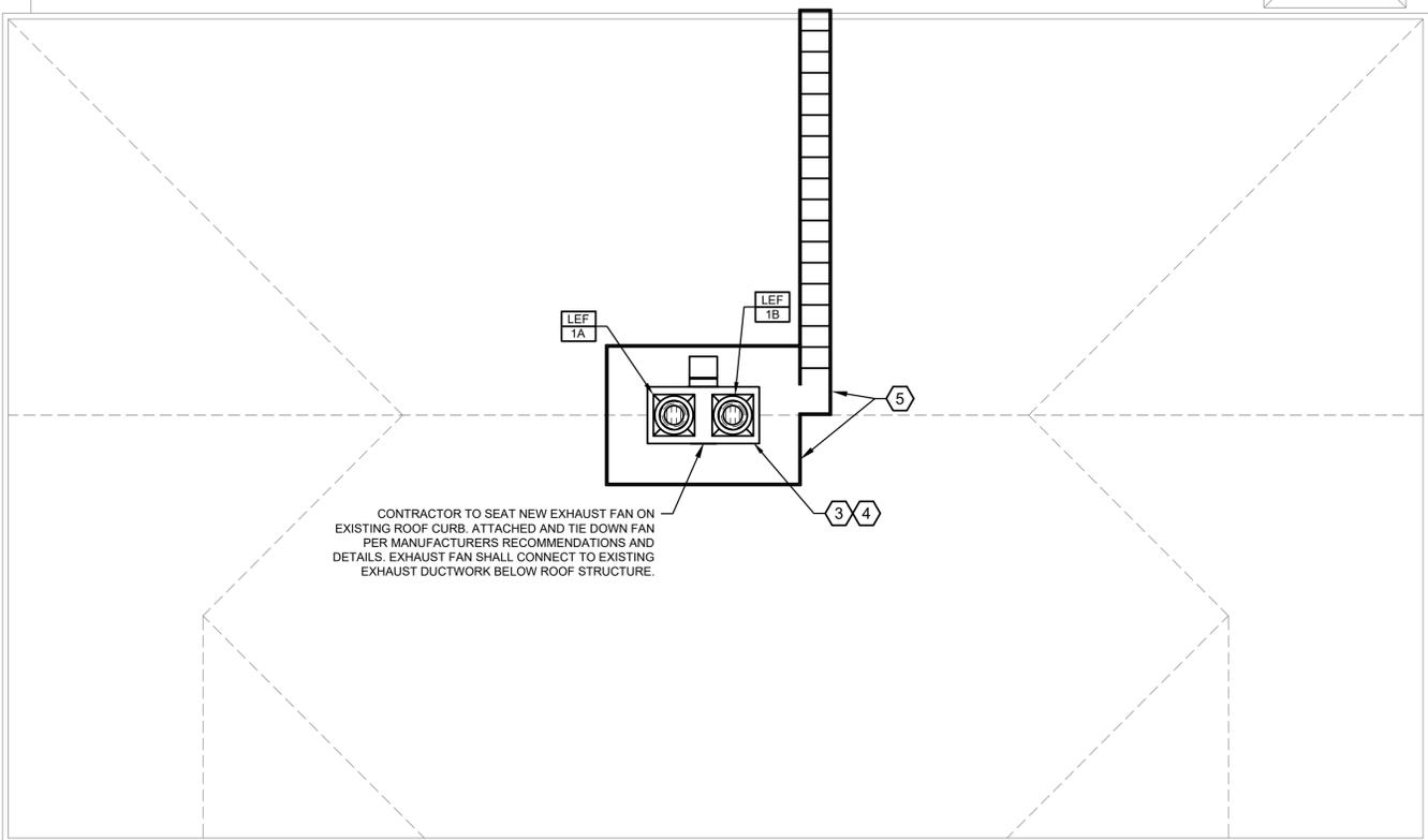
**2 MECHANICAL RENOVATION PLAN: ROOF**
