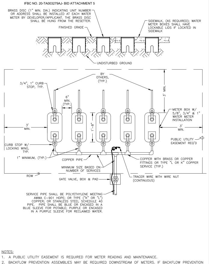
2. BACKFLOW PREVENTION ASSEMBLIES MAY BE REQUIRED DOWNSTREAM OF METERS. IF BACKFLOW PREVENTION ASSEMBLIES SHALL BE LOCATED OUTSIDE OF THE UTILITY EASEMENT.
