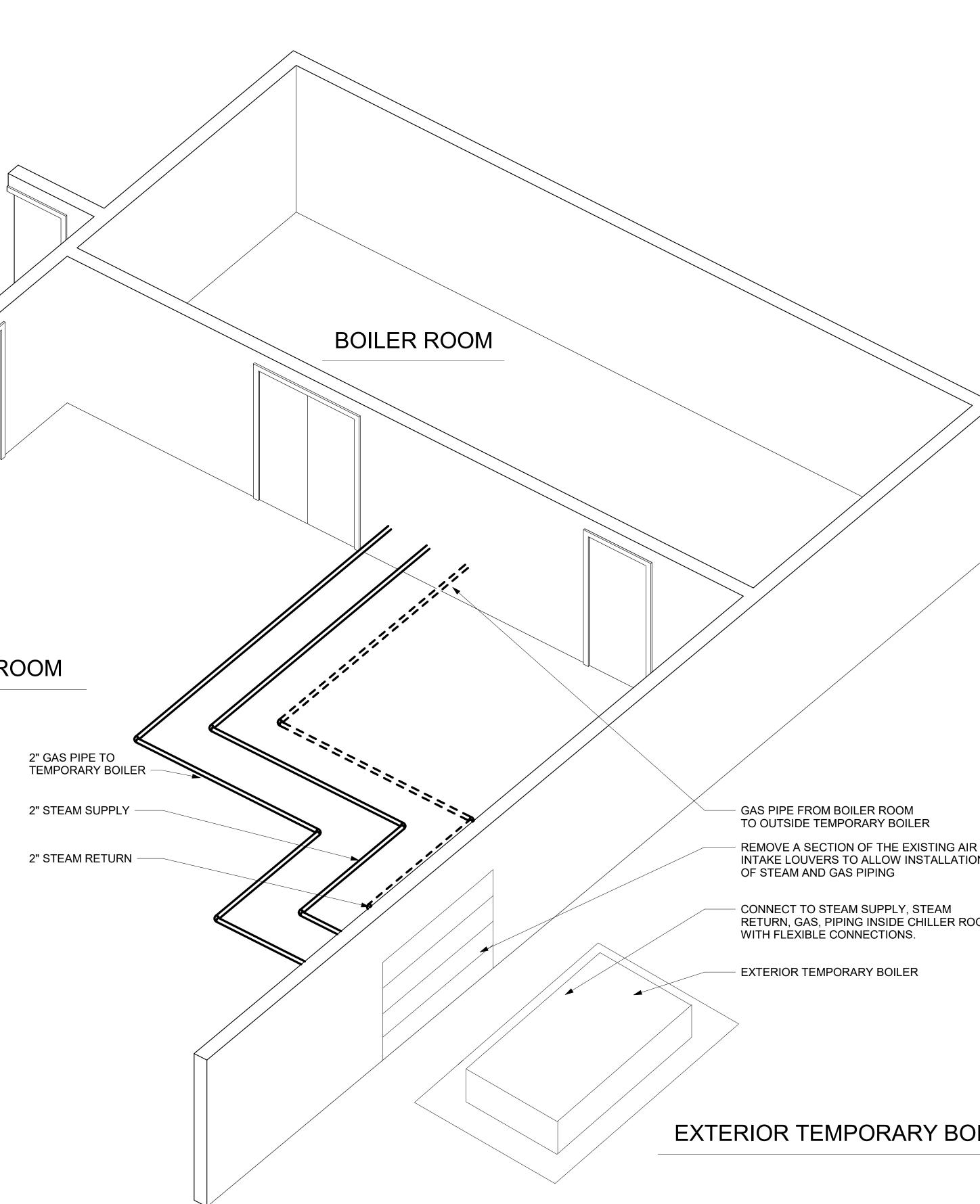
1 TEMPORARY BOILER - ISOMETRIC
