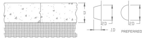
**TYPE 'C' CONSTRUCTION JOINT**
