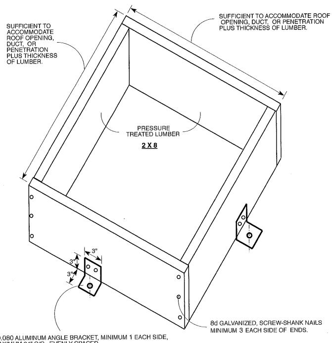
• 0.080 ALUMINUM ANGLE BRACKET, MINIMUM 1 EACH SIDE, MAXIMUM 24" O/C., EVENLY SPACED.
